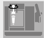
Filter in Wassertank eindrehen
